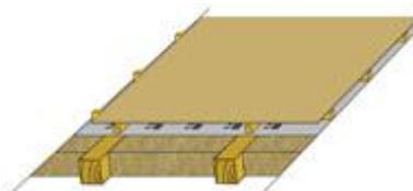
Для эффективной работы пленке необходимо обеспечить удаление паров воды из ограждающей конструкции за счет естественной вентиляции подкровельного пространства. Эту функцию выполняет вентилируемый зазор между кровельным покрытием и пленкой.
