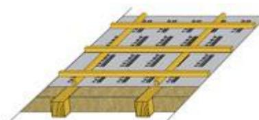
Поверх контреек устанавливается обрешетка в соответствии с применяемой кровельной системой.
