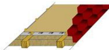
Его толщина как правило определяется толщиной контрейки и обрешетки и составляет 8-10 см. Для обеспечения доступа внешнего воздуха в вентилируемый зазор и удаления паров воды в подшивке карниза предусматриваются вентиляционные отверстия, а в районе конька вентиляционные устройства, соответствующие применяемой кровельной
